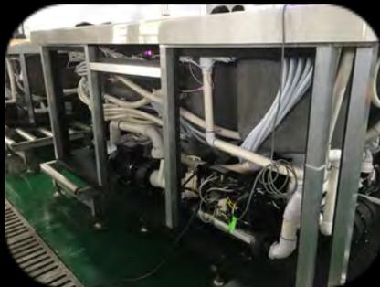
Structure haut de gamme en Aluminium 38 x 38 mm qui offre résistance structurelle et durabilité
